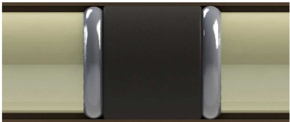
2.6 Сурет – Пакердің резеңкеден жасалған сығылған күйі
